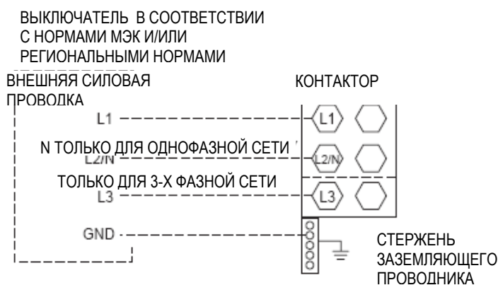
Рис. 4 Подключение к сети электропитания
